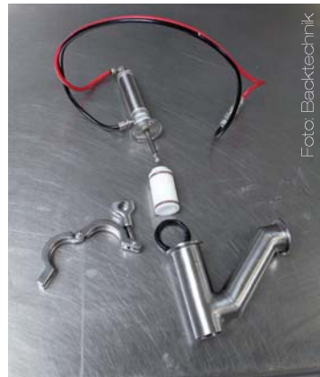
Bilder links und Mitte: Sowohl die Bandanlage mit Steuerung als auch die Dosiermaschine lassen sich im Nassraum mit einer Handbrause reinigen. Bild rechts: Die einzelnen Komponenten lassen sich ohne Werkzeug auseinanderbauen, um sie dann unter Wasser reinigen zu können.
