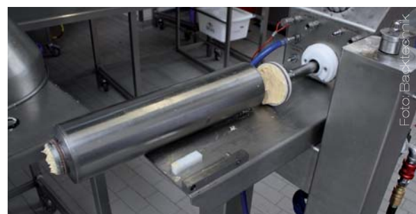
Bild links: Gut zu erkennen sind Füll- und Auslassöffnung, durch welche auch stückige Massen gepumpt werden können. Bild rechts: Die Zylinder sind in verschiedenen Größen erhältlich und müssen entsprechend der Einwaage ausgewählt werden.
