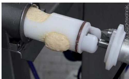
Bild links: Gut zu erkennen sind Füll- und Auslassöffnung, durch welche auch stückige Massen gepumpt werden können. Bild rechts: Die Zylinder sind in verschiedenen Größen erhältlich und müssen entsprechend der Einwaage ausgewählt werden.
