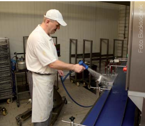
Bilder links und Mitte: Sowohl die Bandanlage mit Steuerung als auch die Dosiermaschine lassen sich im Nassraum mit einer Handbrause reinigen. Bild rechts: Die einzelnen Komponenten lassen sich ohne Werkzeug auseinanderbauen, um sie dann unter Wasser reinigen zu können.
