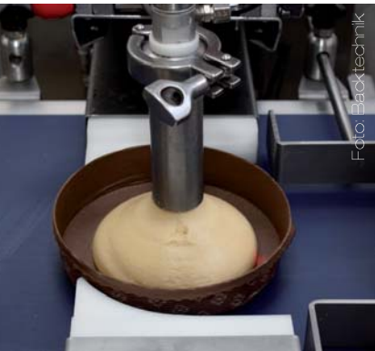
Bild links: Die runden Formen werden von einem Fotosensor erkannt, in den Gates fixiert und mit der entsprechenden Menge an Masse gefüllt. Bild Mitte: Die Erweiterung der Anlage mit einer zweiten Dosierstation wäre denkbar, damit weitere Schritte automatisiert werden können. Bild rechts: Die Einwaage kann über Volumen in Prozent und die Stärke des Zylinders verändert werden.
